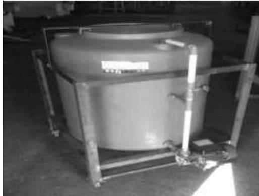
**Gambar 2. Alat Uji Hardenability Yang Telah Dibuat**
