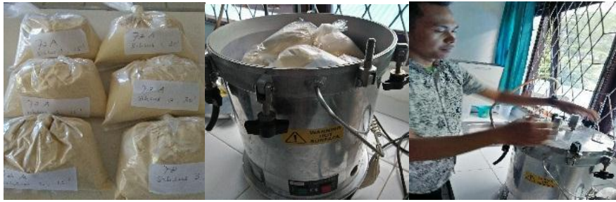
Gambar 4. Modifikasi pati jagung dengan pemanasan-pendinginan
