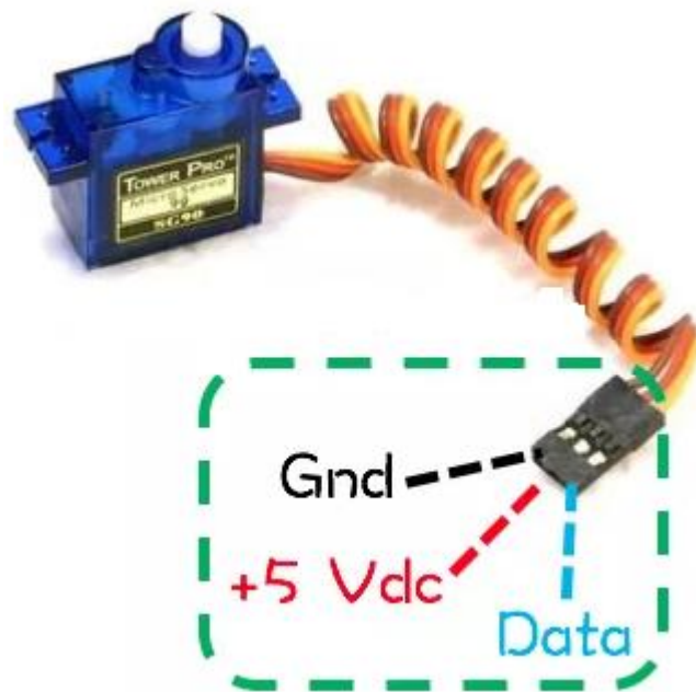
Gambar 13.2. Pewarnaan Kabel Standar Motor Servo
